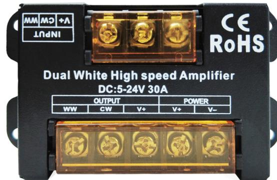
AP-A22 CCT 放大器适用于 PWN 控制的 LED 控制器，能将 LED 控制器的功率放大每增加一个扩尽器就可以多连接一倍至三倍的 LED 灯数量，并且可以级联，理论上可以连持无限个功率扩展器。方便不同电压、大功率和小功率的 LED 灯具统一控制。不论是我司产品或者其他公司的产品，只要是 PWN 控制，电压合适，都可以使用此系列功率扩展器。使用高速光藕设计，可以达到极低的延时时间，以保证多台级联时与主机保持同步
